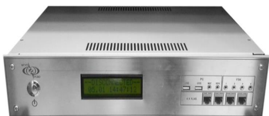
Рис.7.3 Узел сопряжения и контроля
